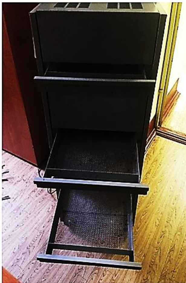
Рис. 1. Экспериментальный аппарат для исследования зависимости температуры инфракрасного излучения на поддоне аппарата без принудительной вентиляции воздуха от мощности излучателя, расстояния от инфракрасного излучателя до сетчатого поддона
