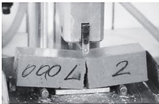
Рис. 1. Разрушение бетонной балки при испытании на изгиб
