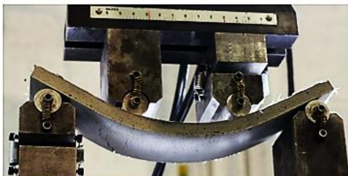
Рис. 3. Испытание гибкого бетона на изгиб
