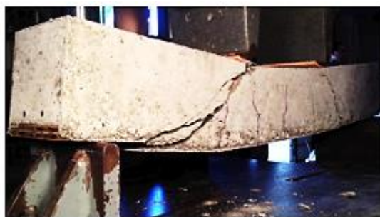
Рис. 2. Образование трещин у железобетонной балки при испытании на изгиб
