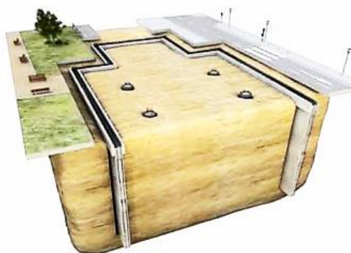
Рис. 1. Пример выполнения конструкции «стена в грунте»
