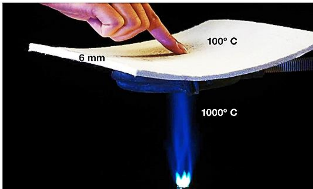
Рис. 5. Пример испытания аэрогелевой изоляционной плиты на воздействие больших температур
