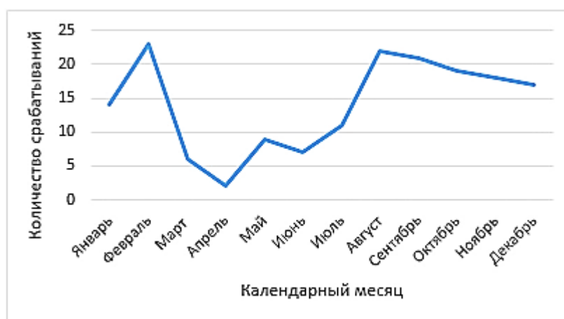
Рис. 2. Зависимость количества неисправностей тормозов от времени года по Восточному полигону
