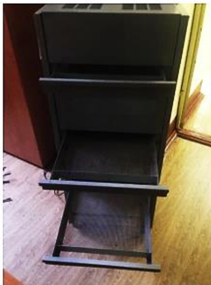
Рис. 1. Экспериментальный аппарат для исследования процесса сушки дубовых опилок инфракрасным излучением с выделенной длиной волны без принудительной вентиляции воздуха
