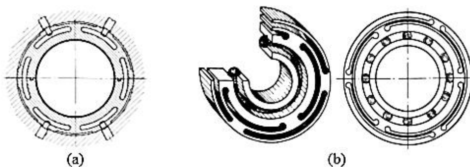
Рис. 3. Упругие опоры ротора: (а) подшипник скольжения, (б) роликоподшипник
