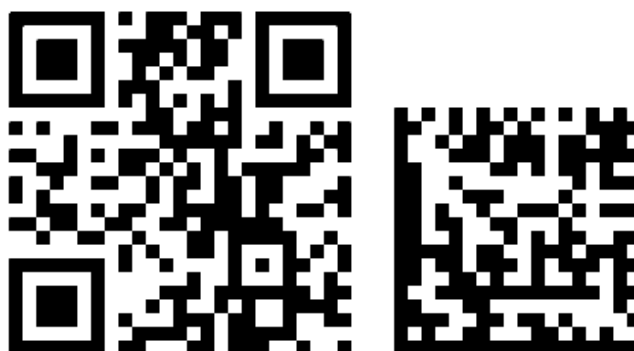
Рис. 3. Примеры QR-кода и DataMatrix-кода
