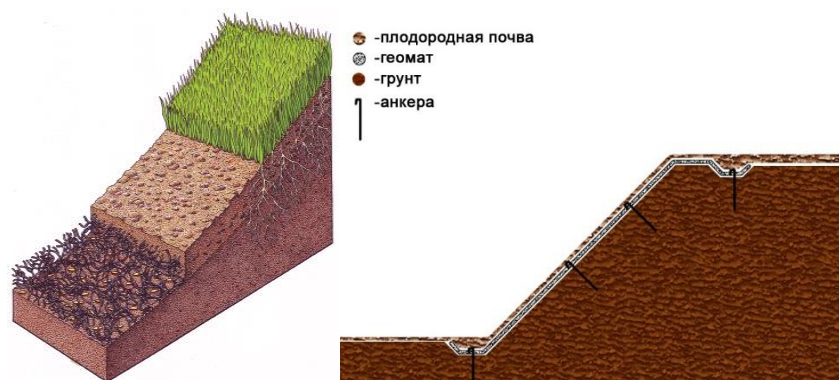
Рис. 2. Закрепленный на откосе геосинтетический мат
