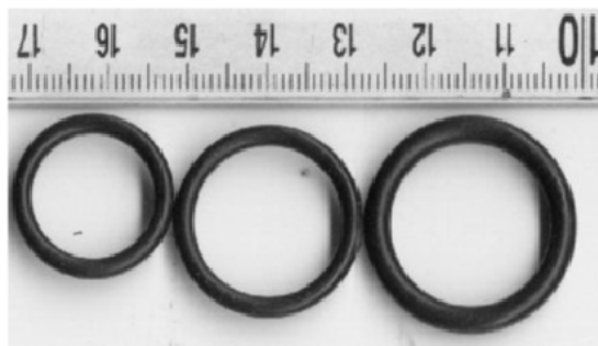
Уплотнительное кольцо круглого сечения (О-ринг, O-ring) — элемент уплотнительного устройства торообразной формы:
