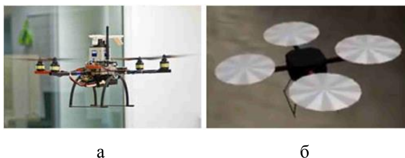
Рис. 1. Четырехроторный БПЛА: фото (а) и модель из Gazebo (б)
