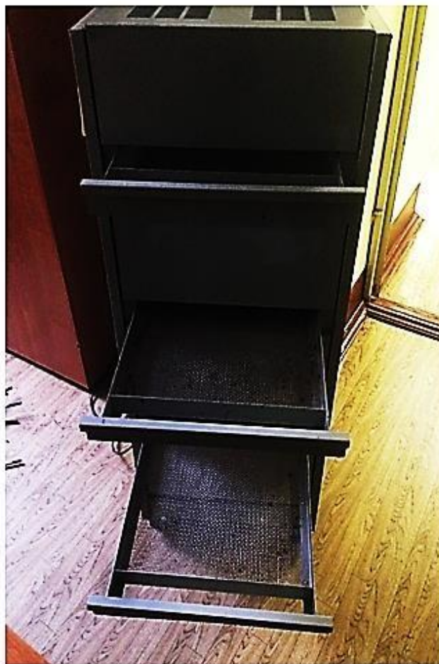
Рис. 1. Экспериментальный аппарат для исследования зависимости температуры инфракрасного излучения на поддоне аппарата без принудительной вентиляции воздуха от мощности излучателя
