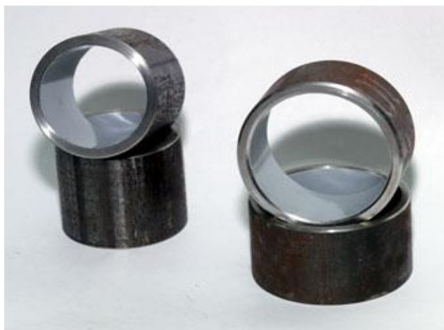
Рис. 2. Образец НКТ с внутренним покрытием
