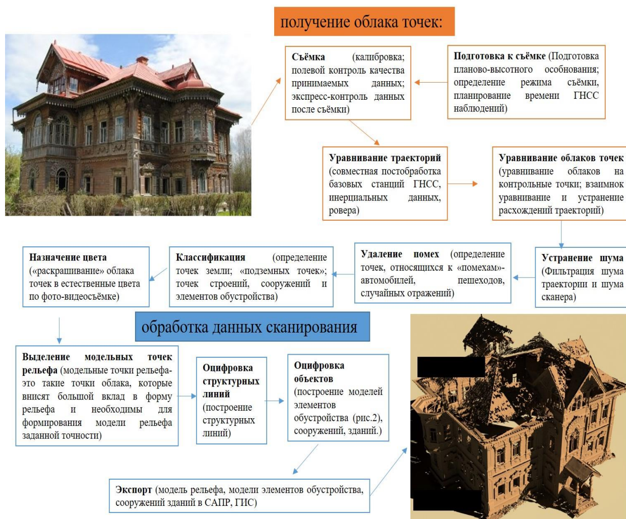
Рис.1. Процесс получения 3Д-модели здания применяя метод 3Д сканирования
