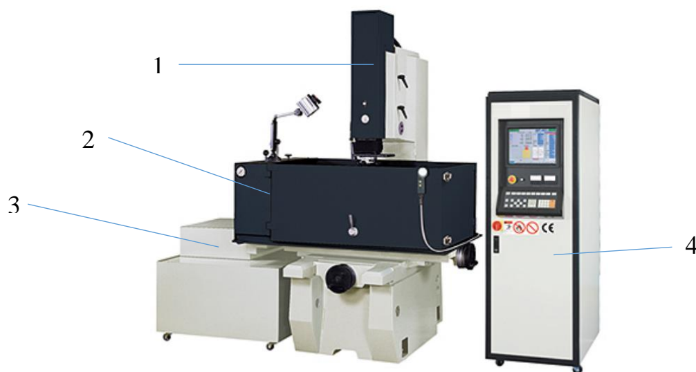
Рис. 3. Станок 4Л723Ф1–04: 1 – шпиндельный узел; 2 – стол с ванной; 3 – бак для рабочей жидкости; 4 – генератор
