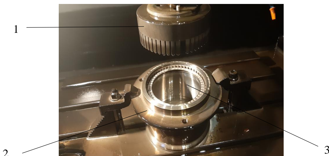
Рис. 2. Приспособление для закрепления детали «Цилиндр блока камеры»:
