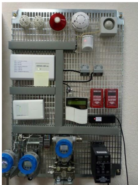
Рис.1. Имитационный охранно-пожарный стенд
