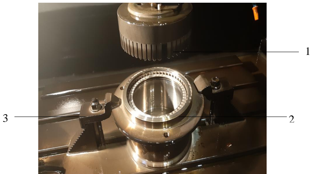
Рис. 3. Приспособление для закрепления детали «Цилиндр блока камеры»:
