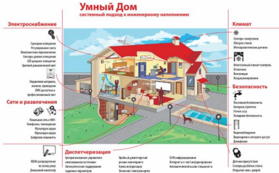
Рис. 2. Инженерное наполнение умного дома
