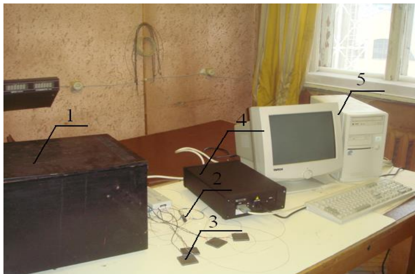
Рис. 1. Экспериментальный стенд для исследования процесса подсушки кукурузного крахмала инфракрасным излучением. 1 – сушильная камера, 2 – хромель-алюмелевые ТХА 9419-23 термопары, 3 – датчики плотности теплового потока ДТП 0924-Р-О-П-50-50-Ж-О, 4 – измеритель теплопроводности ИТ-2, 5 – персональный компьютер
