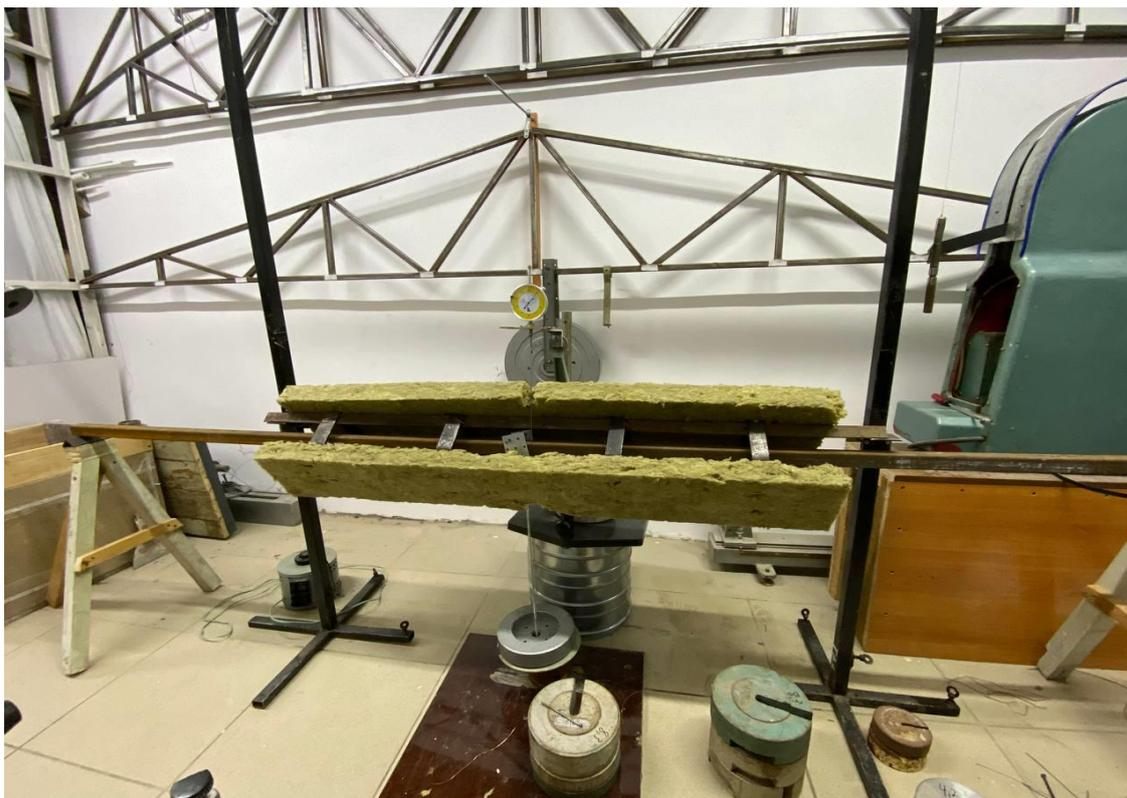
Рис. 1. Установка для проведения измерений прогиба
