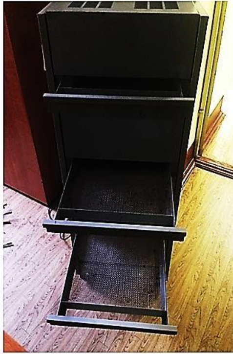
Рис. 1. Экспериментальный аппарат для исследования процесса сушки листьев базилика инфракрасного излучения на поддоне аппарата без принудительной вентиляции воздуха от мощности излучателя
