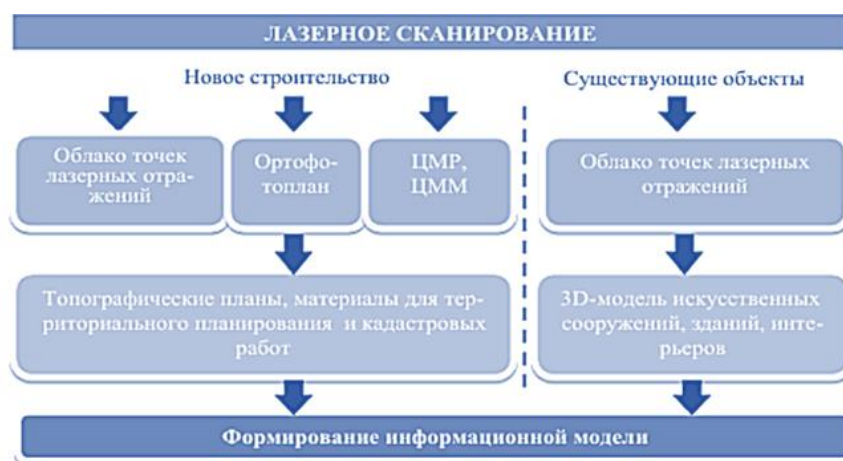
Рис. 1. Схема формирования информационной модели
