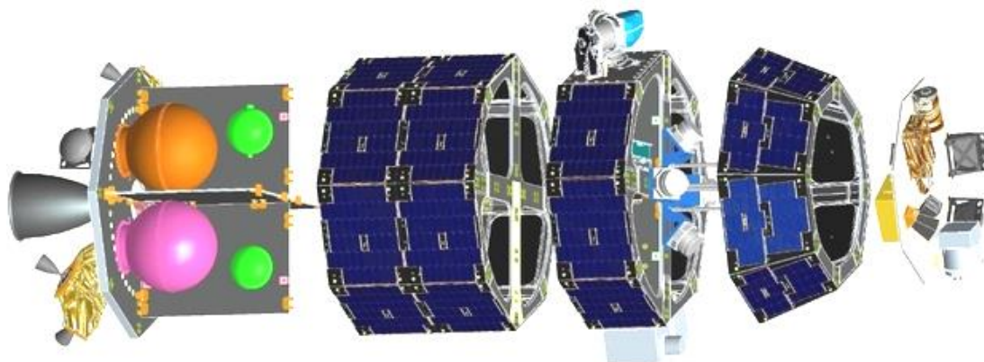
Рис. 2. КА LADEE в частично разобранном виде
