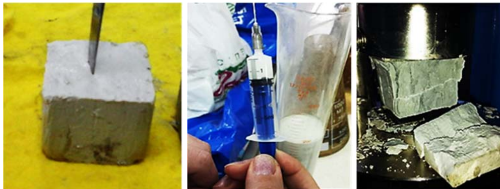
Рис. 1. а) шлаковый камень при комнатной температуре, через 24 часа; б) водотделение шлакового раствора после 30 мин после затворения; в) шлаковый камень после испытания на сжатие
