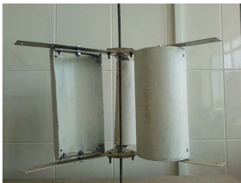
Рис. 3. Ветроэнергетическая установка с вертикальными полуцилиндрическими лопастями
