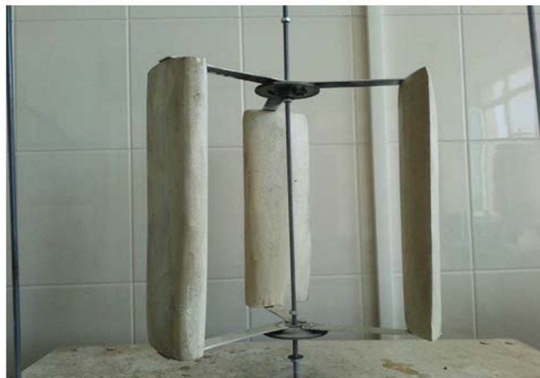
Рис. 2. Ветроэнергетическая установка с вертикальными лопастями крылового профиля
