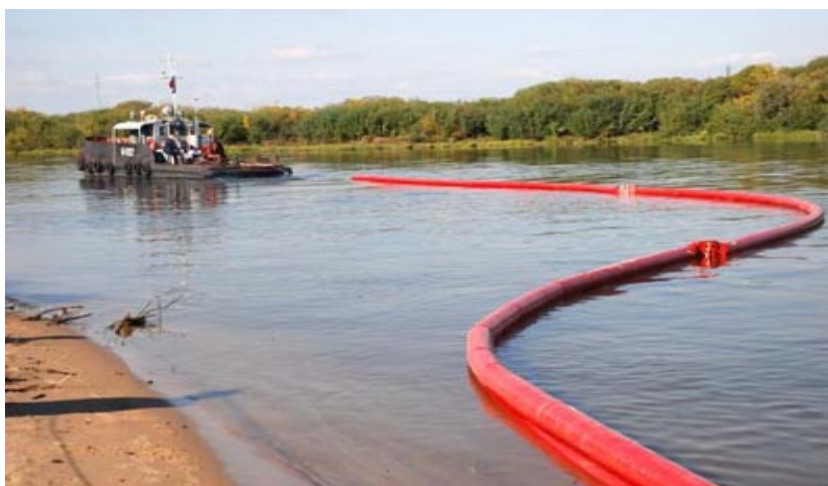
Рис. 4. Бонопостановщик устанавливает заградительные боны, чтобы нефть не растекалась по реке
