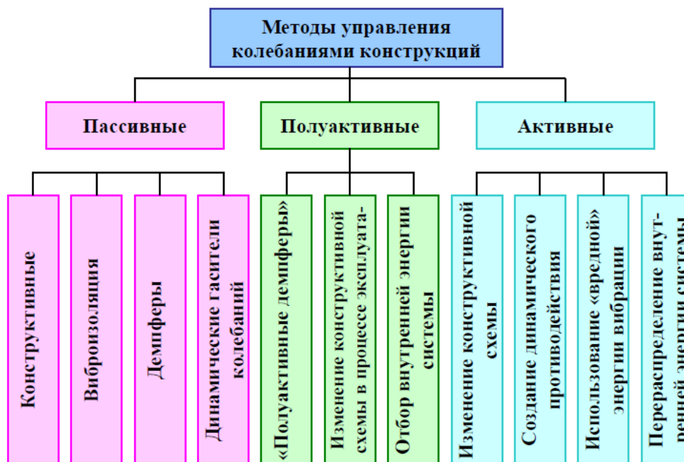
Рис. 1. Методы управления колебаниями конструкций
