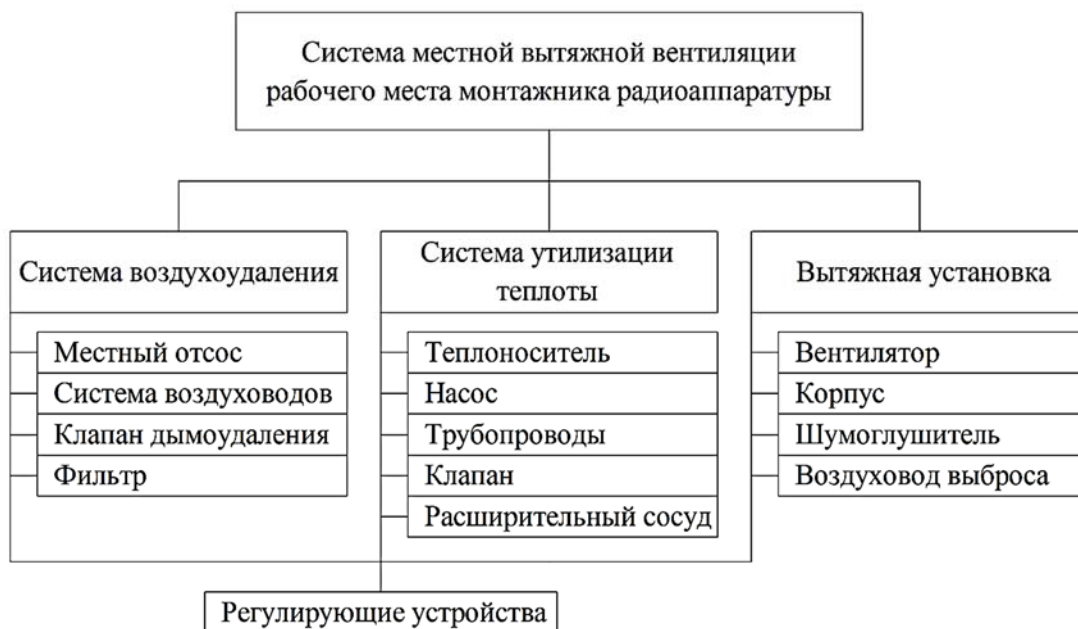
Рис. 1. Структурная модель системы местной вытяжной вентиляции
