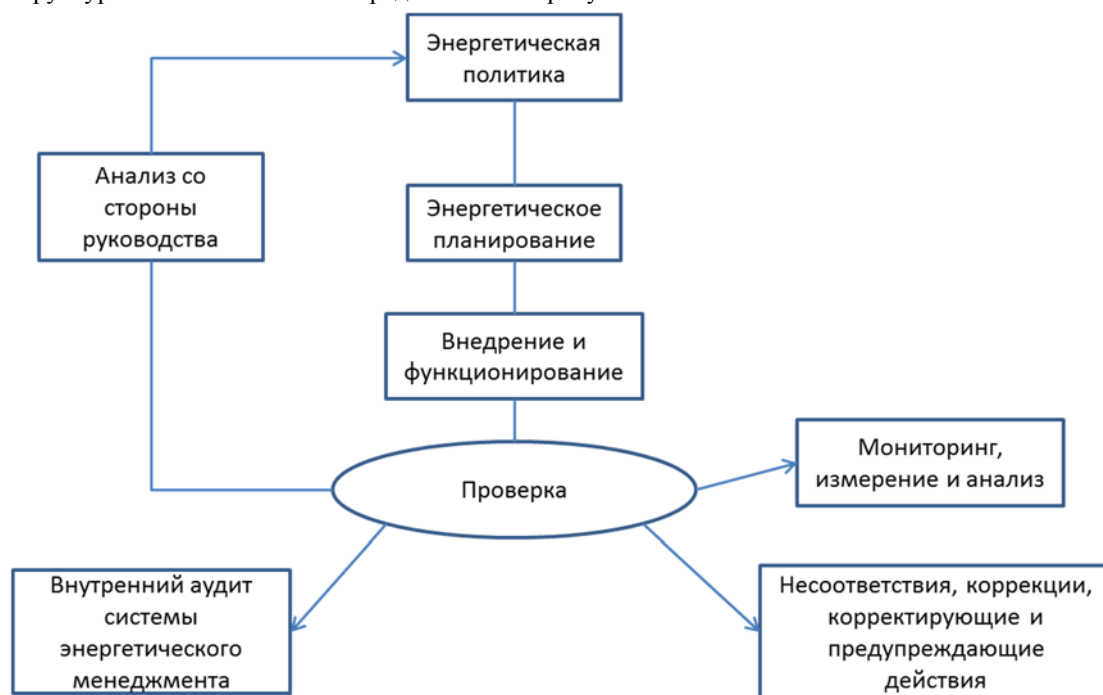
Рис. 1. Структура СЭМ согласно ГОСТ Р ИСО 50001–2012.
