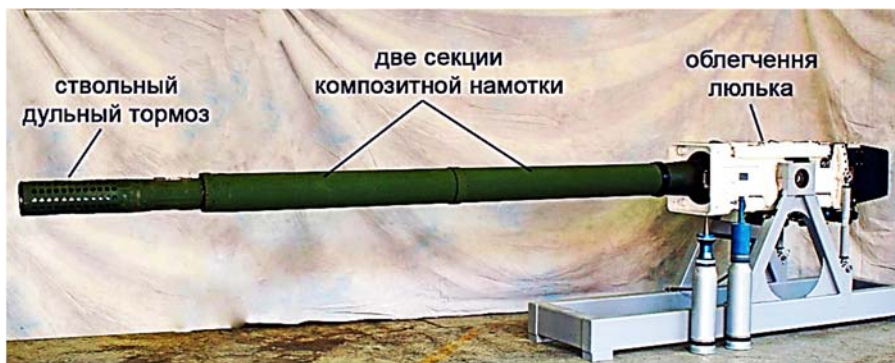
Рис. 1. Новая 120-мм пушка XM360 для танка MCS
