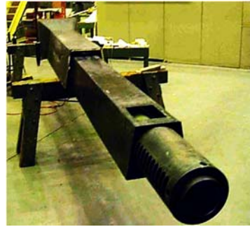
Рис. 5. Кожух, установленный на стволе
