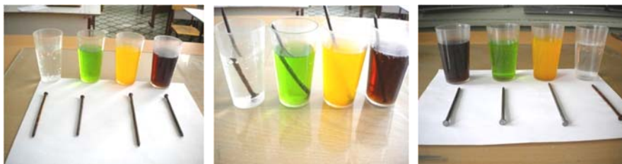
Рис. 3. Влияние кислой среды газированных напитков на ржавчину: слева – начало опыта, посередине – через 1 час, справа – через 24 часа
