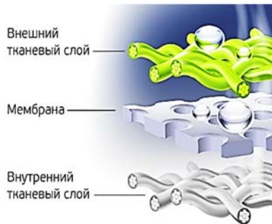
Рис. 6. Схема расположения мембраны
