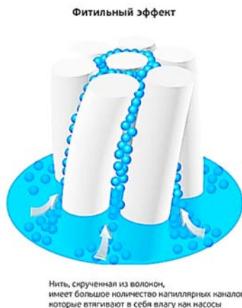
Рис. 2. Схематичное изображение принципа работы гидрофильных тканей
