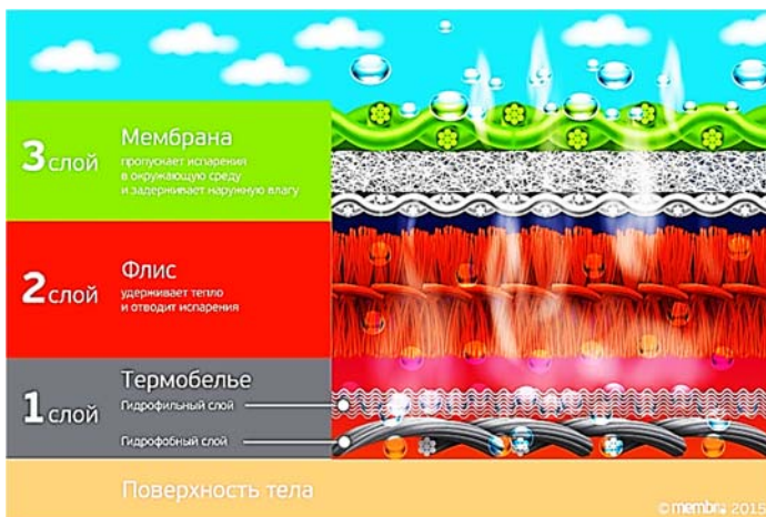
Рис. 7. Схема трехслойной системы одежды «outdoor»
