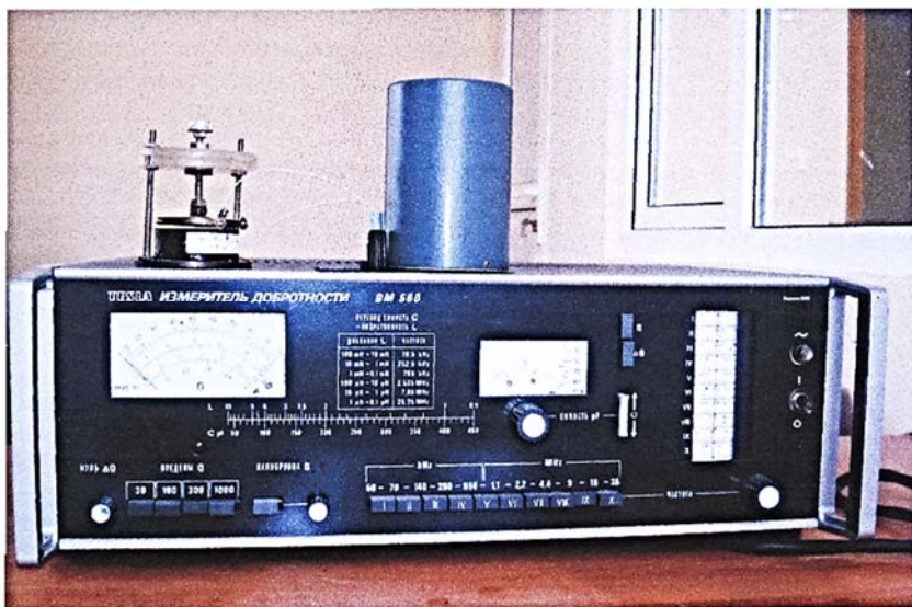
Рис. 1. Общий вид прибора «Измеритель добротности» ВМ – 560
