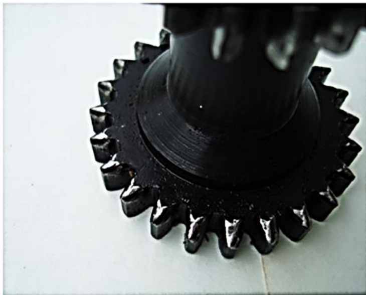
Рис. 5. Износ и смятие зубьев большой сдвоенной шестерни
