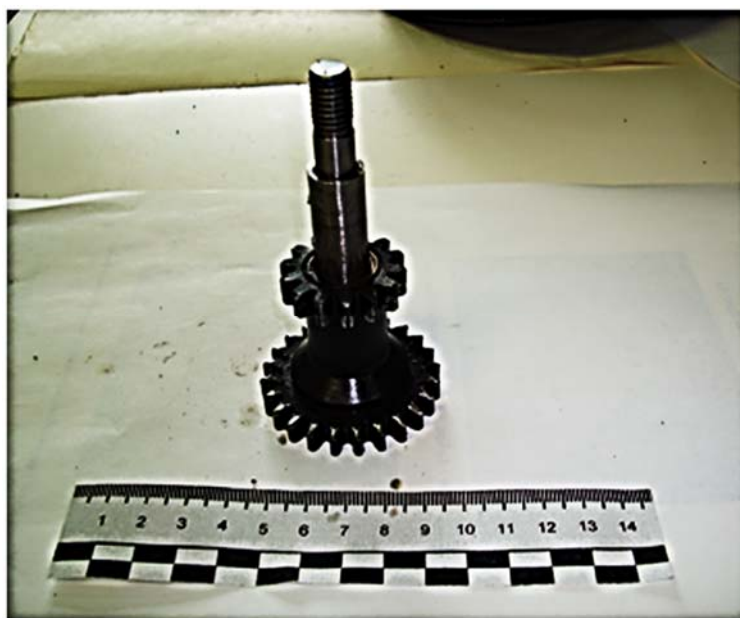
Рис. 4. Сдвоенная большая шестерня с синей краской на концах вала
