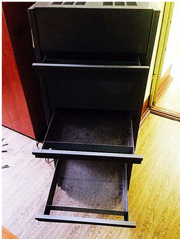
Рис. 1. Экспериментальный аппарат для исследования процесса сушки измельченной цветной капусты инфракрасным излучением
