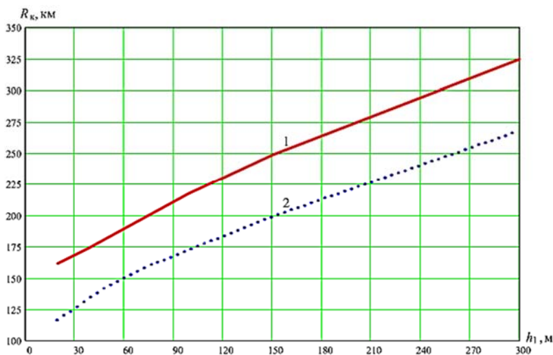
Рис. 2. Сравнение координационных расстояний для аналоговых (1) и цифровых (2) передающих станций
