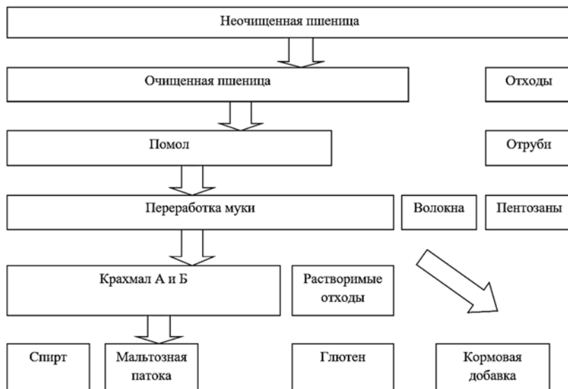
Рис. 1. Схема технологического процесса глубокой переработки пшеницы
