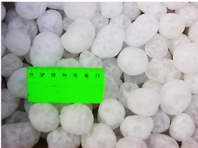
Рис. 1. Овально-сферические гранулы льда, полученные с интенсивной циркуляцией при намораживании воды
