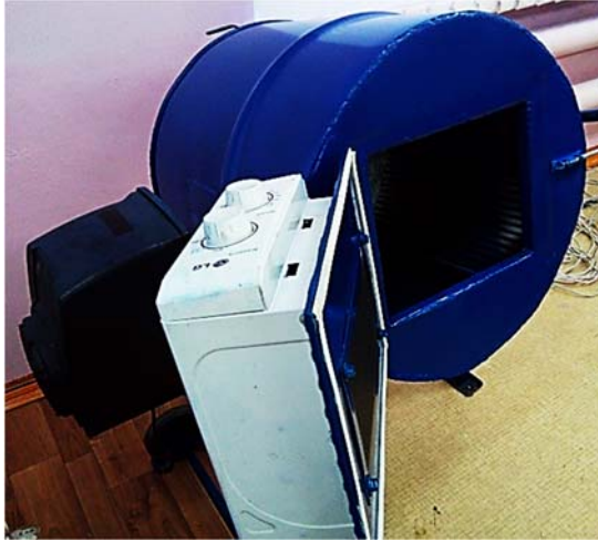
Рис. 1. СВЧ установка для массирования и термообработки мясного сырья
