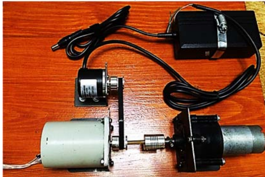
Рис. 1. Структурная схема. Лабораторный комплекс для исследования процессов в шаговых двигателях
