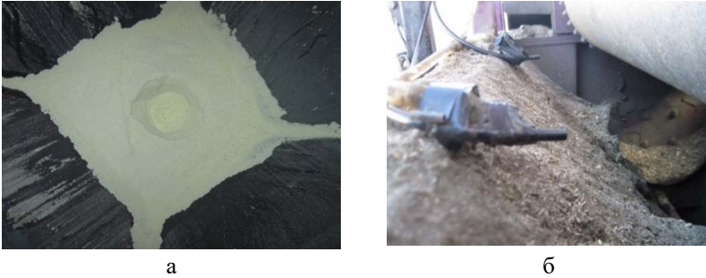
Рис. 4. Вывод консерванта: а – консервант в емкости; б – выходные каналы
