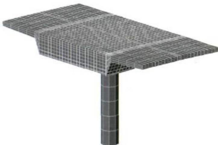
Рис. 7.2. Расчетная конечно-элементная модель надопорной зоны пролетного плитного строения
