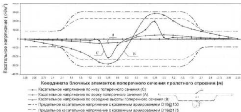
Рис. 7.6. Распределение касательных напряжений t_K в поперечном сечении
