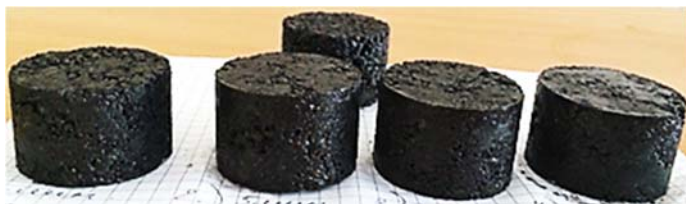
Рис. 1. Брикеты, спрессованные из металлизированной мелочи и шлама цеха №1 ГБЖ ОО «ЛГОК»
