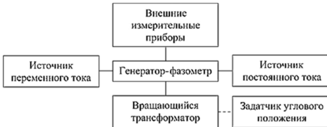
Рис. 2. Структурная схема лабораторного стенда «Исследование вращающихся трансформаторов»
