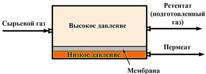
Рис. 1. Принципиальная схема мембранного газоразделения
