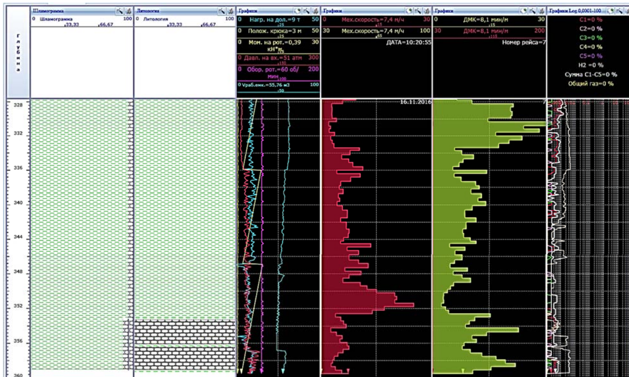
Рис. 1. Фрагмент глубинной диаграммы станции ГТИ СНГС-100
