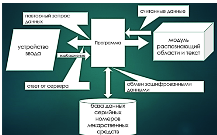
Рис. 3. Примерная схема системы проверки фармацевтических препаратов
