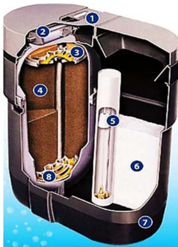
Рис. 4. Компоновка ионообменного фильтра «Аквадин-про»:
