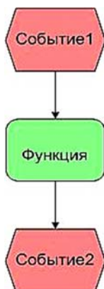
Рис. 2. Модель нотации eEPC. Событие – Функция
