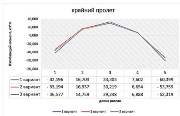
Рис. 4. Сравнительный анализ значений изгибающих моментов в ригеле крайнего пролета
