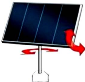
Рис. 4. Трекер с двумя осями вращения на несущем столбе
