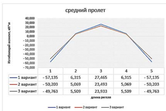
Рис. 5. Сравнительный анализ значений изгибающих моментов в ригеле среднего пролета
