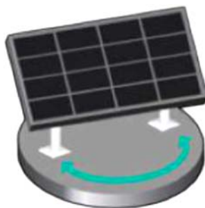
Рис. 2. Трекер с вертикально ориентированной осью вращения
