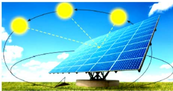
Рис. 5. Трекер с двумя осями вращения и опорной плоскостью
