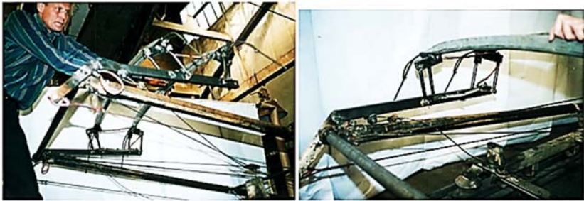
А) Положение токосъемных вставок (на каретке) при прохождении пересечек и перекрестков на контактной сети
