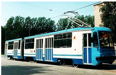
Рис. 1. На фото показан 1-й образец нового типа токоприемника Белова ТПБ.00.00
