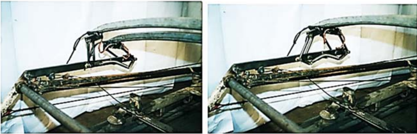
Б) Положение токосъемных вставок при ударных нагрузках об изолированные участки
