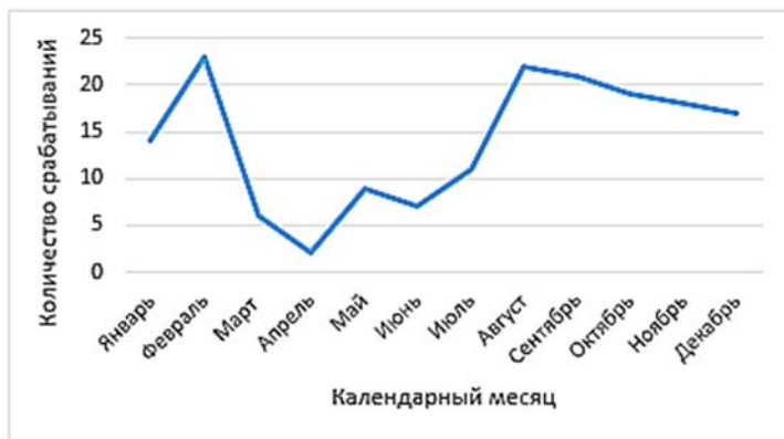
Рис. 2. Зависимость количества неисправностей тормозов от времени года по Восточному полигону
