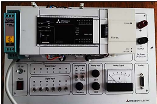
Рис. 1. Учебный стенд на базе контроллера FX5U-32M
