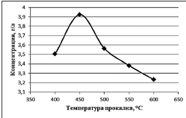
Рис. 3. Зависимость концентрации цинка в растворе после выщелачивания от температуры прокалива пыли
