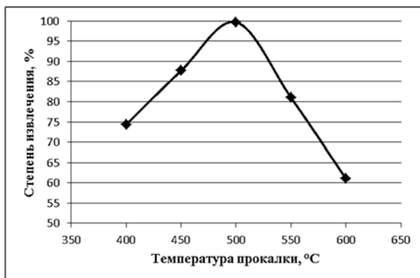
Рис. 1. Зависимость степени извлечения мышьяка от температуры прокаливания пыли
